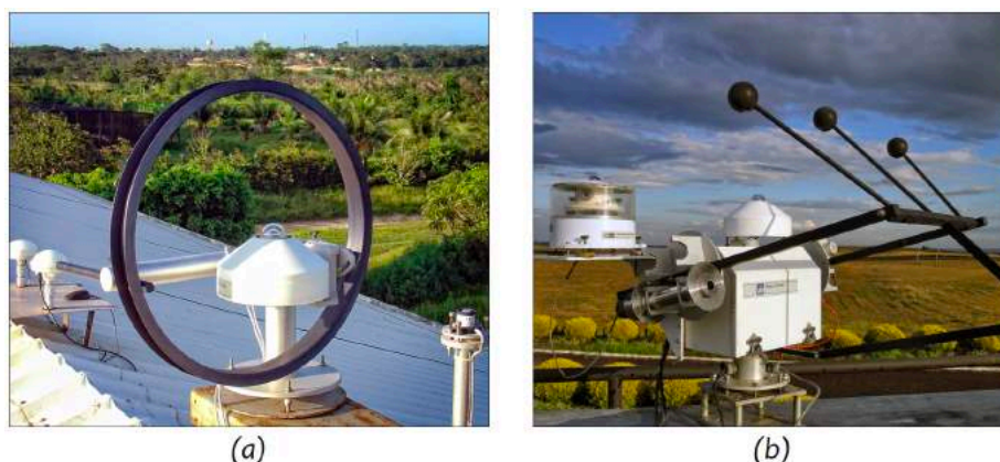
Figura 20 - Estrutura de sombreamento do piranômetro: (a) Anel de sombreamento, (b) Esfera de sombreamento
